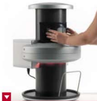
Ekstraoralnie pamięciowe płyty obrazowe są wkładane w elastyczne kasetki na płyty.
