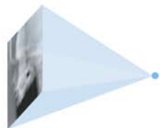
Zasada cyfrowego zdalnego zdjęcia rentgenowskiego z użyciem pamięciowej płyty obrazowej. Czas naświetlania: ok. > 0,4 sek.
